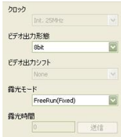
図 5-2-2 露光モード（トリガーモード）、ビデオ出力形態設定
