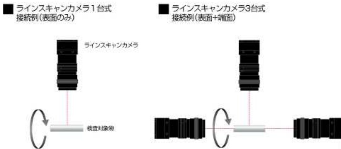
図 1-2 円筒状表面外観検査カメラ構成
